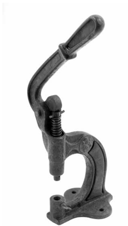
Сл. 10 - Машина за сјавање ринџица, Чачак, прва половина XX века, ИБ Е 1389
