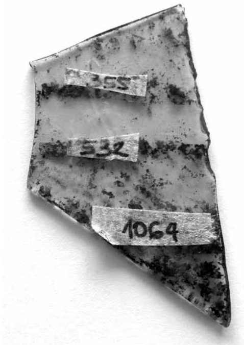
Сл. 12 - Уйоредно лазерско чишћење фрајментїа сїакла (їталасна дужина 355 нт, 532 нт, 1064 нт)
