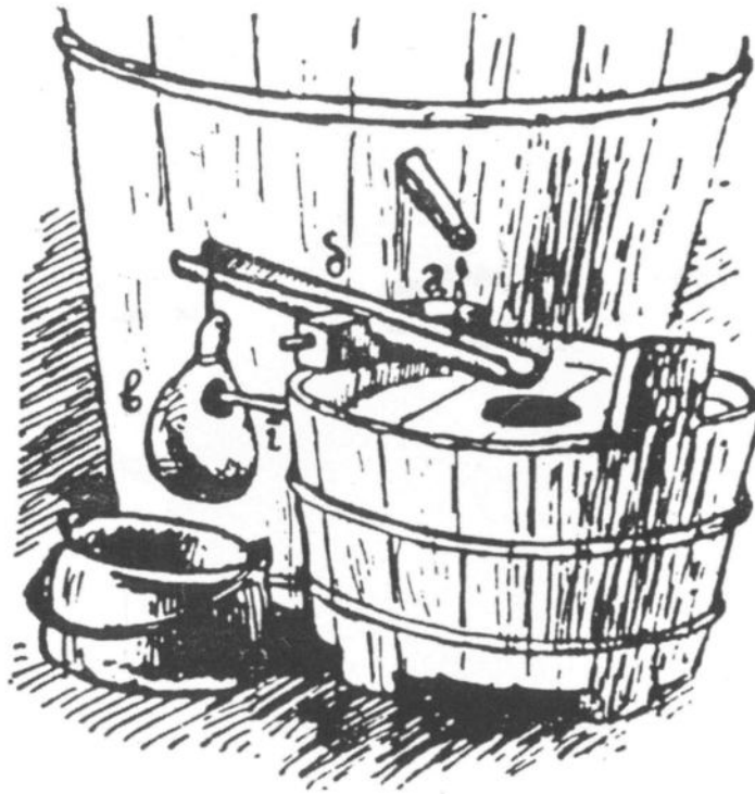
Претега на постави, Блазнава (Јасеница) а) јастук; б) жлеб; ц) тиква, врг; д) цевчица
