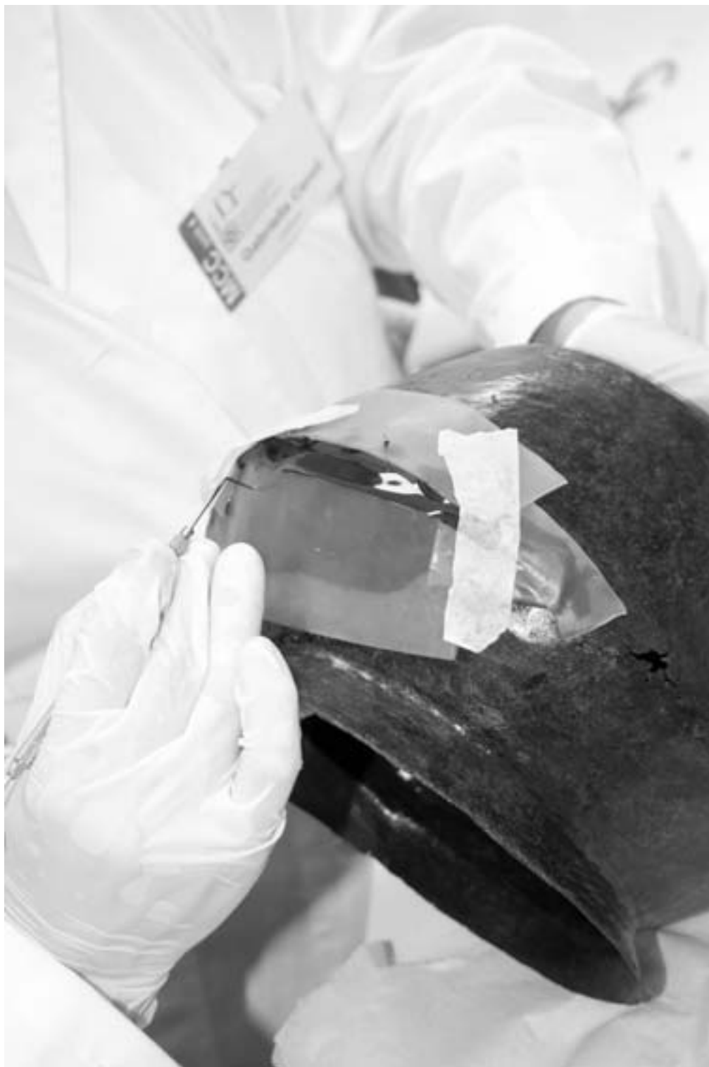
Сл. 14 - Истискивање мехурића ваздуха из епоксидне смоле (поштомачки очувано ведро)
