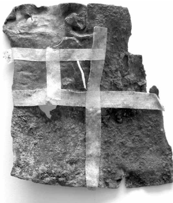
Сл. 6 - Упоредни испитови ласерској, механичкој и хемијској чишћења бронзаног предмета
